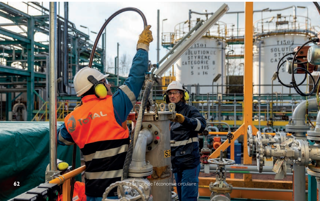
Équipement de recyclage du polystyrène : étape de filtration de la matière.
