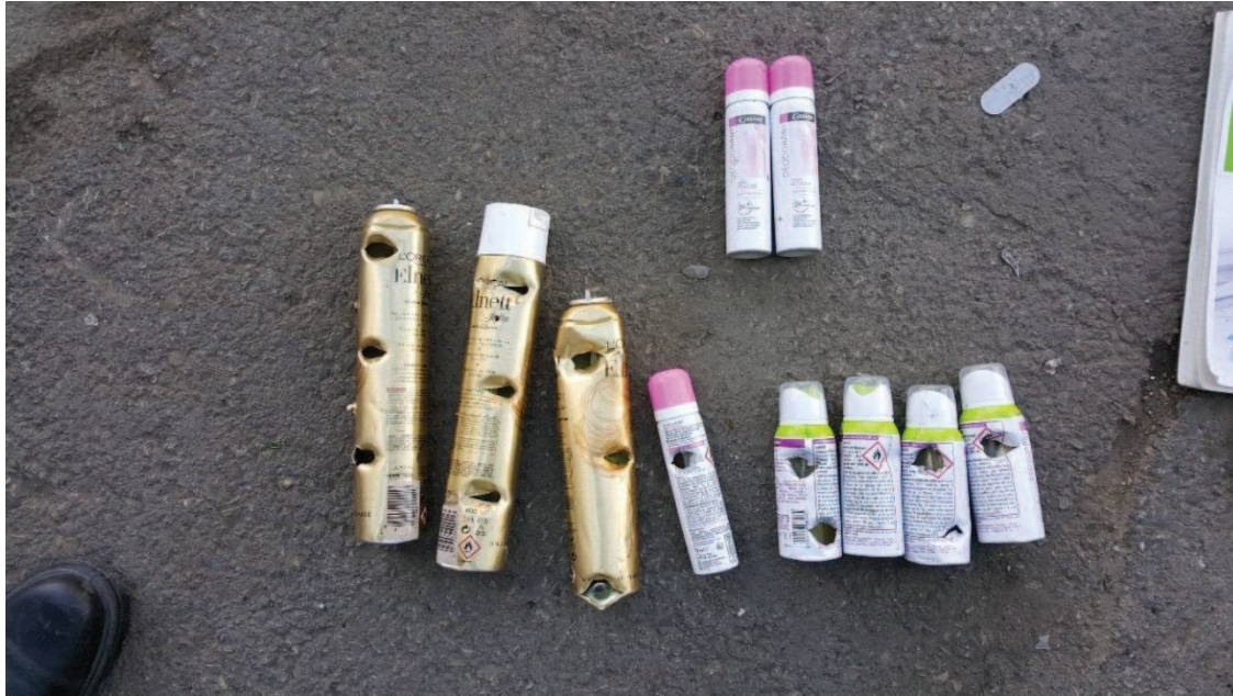
Figure 9 : GAA percés lors de la phase de test du 01 mars 2017
